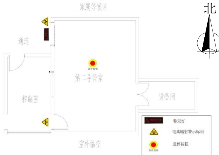
图10-1 第二导管室辐射安全设施布置图
